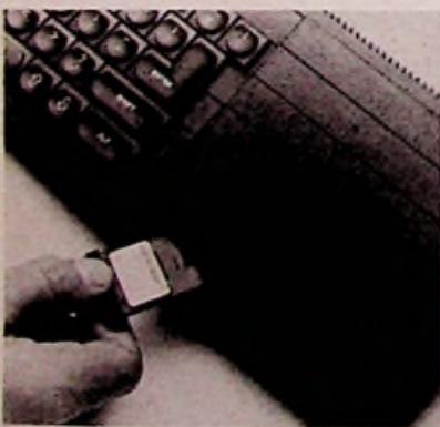
Afb. 1 QL-microdrive met een minicassette waarin een eindeloze band is ondergebracht. In de QL zijn twee microdrives aanwezig.
